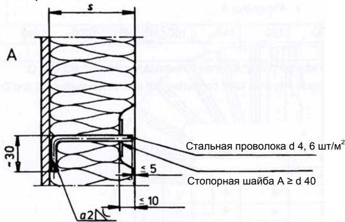
Способ изоляции В используется для изоляции плотностью более  $25 \text{ кг/м}^2$ .
