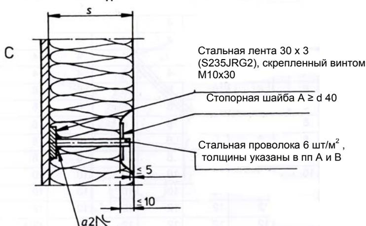
В качестве альтернативного варианта, изоляционный материал может также закрепляться оцинкованной или нержавеющей стальной лентой 16 мм х 0,5 мм с шагом 300 мм.
